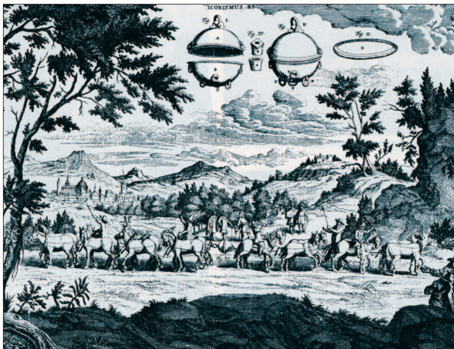
Bild 3: Zeitgenössischer Stich mit dem Halbkugelversuch für die sogenannten „Magdeburger Experimente“ von 1654 zur Wirkung des Vakuums in einem geschlossenen evakuierten Raum des Magdeburger Bürgermeisters und Erfinders Otto von Guericke [2]
