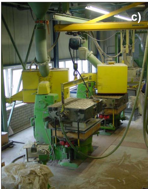
Bild 2: Mechanisierte Formenfertigung beim Vakuumformverfahren (Bilder: eurotech castings Venlo (NL))
