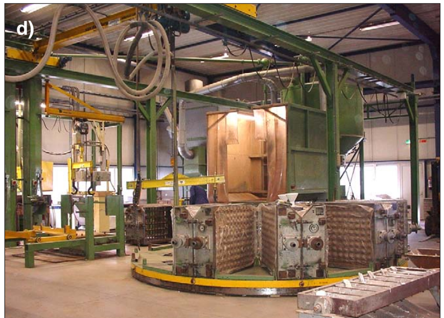
Bild 2: Mechanisierte Formenfertigung beim Vakuumformverfahren (Bilder: eurotech castings Venlo (NL))
