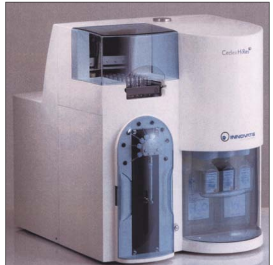
Bild 10: Medizintechnisches Zellkulturanalysegerät der alten (links) und neuen (rechts) Generation mit einem komplexen Gehäuse aus AlSi7Mg, das als Integralgussteil im Vakuumformverfahren gefertigt wurde (Bild: Eurotech Castings, Venlo (NL))
