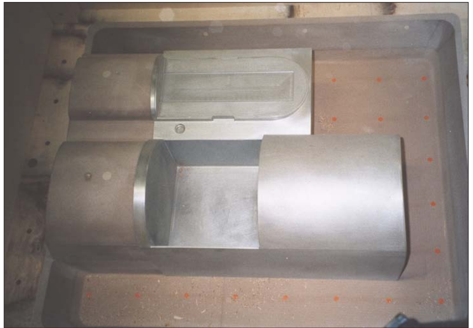
Bild 4: Teil einer Modelleinrichtung für das Vakuumformverfahren mit Modellen aus Metapor (Bild: Eurotech Castings, Venlo (NL))
