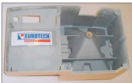
Bild 9: Gehäuse für ein dentaltechnisches Druckformgerät, welches im Gusszustand beschichtet wurde (Bild: Eurotech castings, Venlo (NL))
